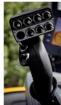
A partir du Monolevier ergonomique, on peut contrôler la vitesse d'avancement, les commandes de la rampe, la pulvérisation ainsi que l'inclinaison de la manche à air (si équipé).
