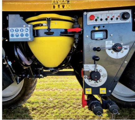
Le compartiment de gauche comprend les vannes de mise en œuvre du remplissage, de l'incorporation et du rinçage et le panneau de commande électrique intégrant l'activation de la pompe et un arrêt d'urgence de la machine qui coupe le moteur.
