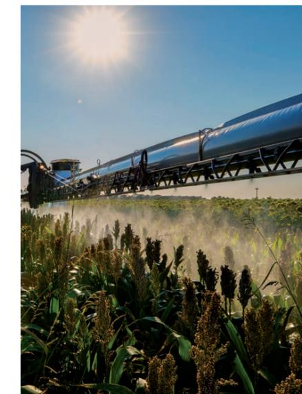
Les rampes Ti-M sont disponibles avec des bras en acier inoxydable (option) avec traitement par ElectroPolissage pour offrir une protection accrue, un nettoyage facilité et un look brillant unique. La rampe Ti-M est spécifiquement conçue pour les cultures à forte valeur ajoutée et toute la série peut accueillir la manche à air. Un outil nécessaire pour une couverture parfaite des feuilles, permettant d'augmenter la pénétration et de réduire considérablement la dérive.
